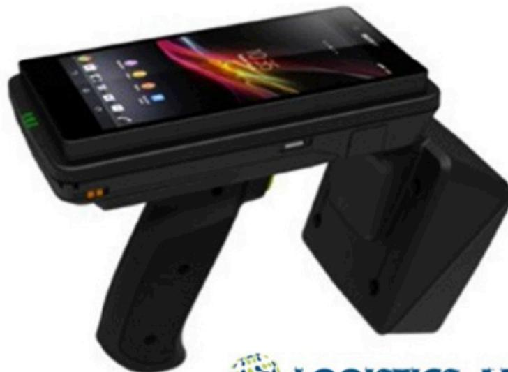
Das Prüfgerät: ein Smartphone, per Bluetooth verbunden mit RFID-Reader und Brandproof-Detektor (Fluoreszenzmessung), erkennt den Marker und die zugeordnete Transportseinheit als Original.
