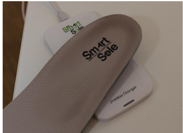
Der Akku in der SmartSole wird induktiv geladen. So muss kein Kabel an der Sohle angeschlossen werden.
